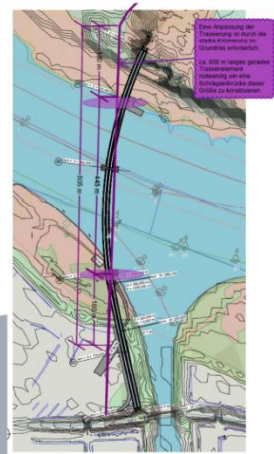
Bild 4: Ausschlusskriterium: Pfeiler in der Elbe (linke Zeichnung), gerade Brücke durch FFH-Gebiet (rechte Zeichnung)
